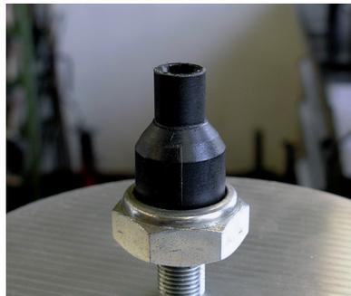
Die neueren Öldruckschalter können die Montage des Zünddeckels behindern. Entweder einen Schalter der älteren Bauform ( mit Flachsteckanschluss 6.3 ) verwenden oder wie Abb. die Isolierung des Schalters kürzen.
